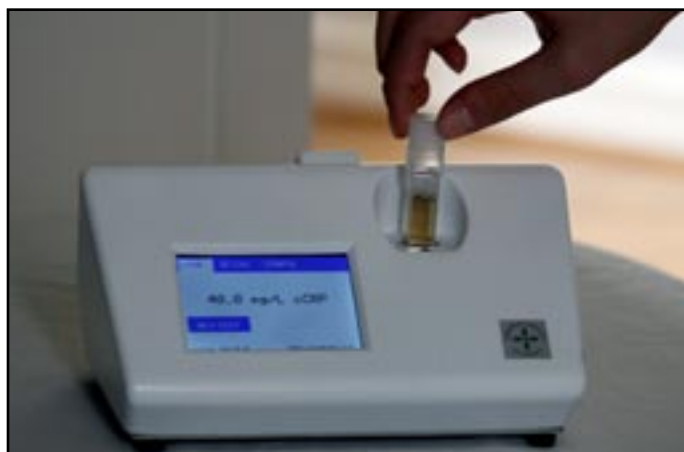
EURIS TurboReader™ veterinärt instrument för patientnära (POC) blodmätning av hund-CRP. Instrumentet erhöll ett EMC CE-godkännande enligt EN61326-1:2013 och EN61326-2-3:2013 vilket innebär att det uppfyller kraven på elektromagnetisk kompatibilitet (d v s att det inte kan störas av och inte blir störd av annan elektrisk utrustning) och att denna delkomponent i bolagets blodanalyssystem får säljas till kunder inom EU. Med instrumentet kan 15 stycken blodanalyser av bl a hund-CRP (inflammationsmarkör) göras per timme. Vid batteridrift kan instrumentet användas under en hel arbetsdag utan tillgång till nätspänning.
