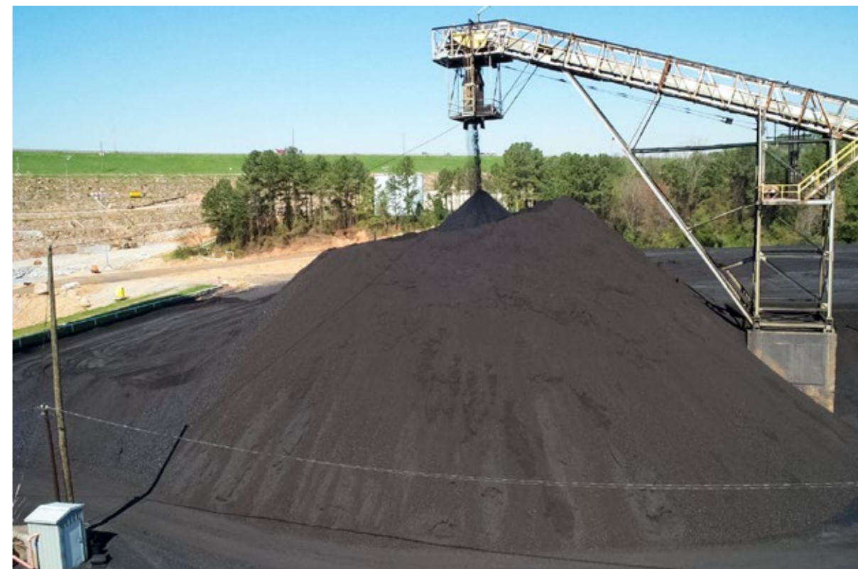
Kol från leveranståg lagras via transportband, vid förbränningsanläggning i USA.
