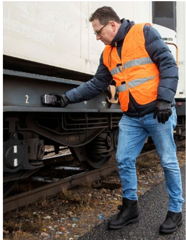
PMU:n monteras med en kraftfull magnet på den fjädrande massan.
