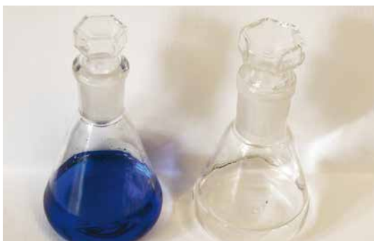
Effekt av EcoFilter® på en blå vattenlösning. Efter rening är lösningen helt klar. Filtret tar bort antibiotika med lika stor effektivitet.
